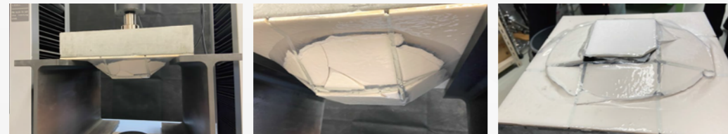
コンクリート押し抜きテスト 1㎡当り3tの重さに耐えられます テスト後(タイルは割れても塗膜は破れない)
